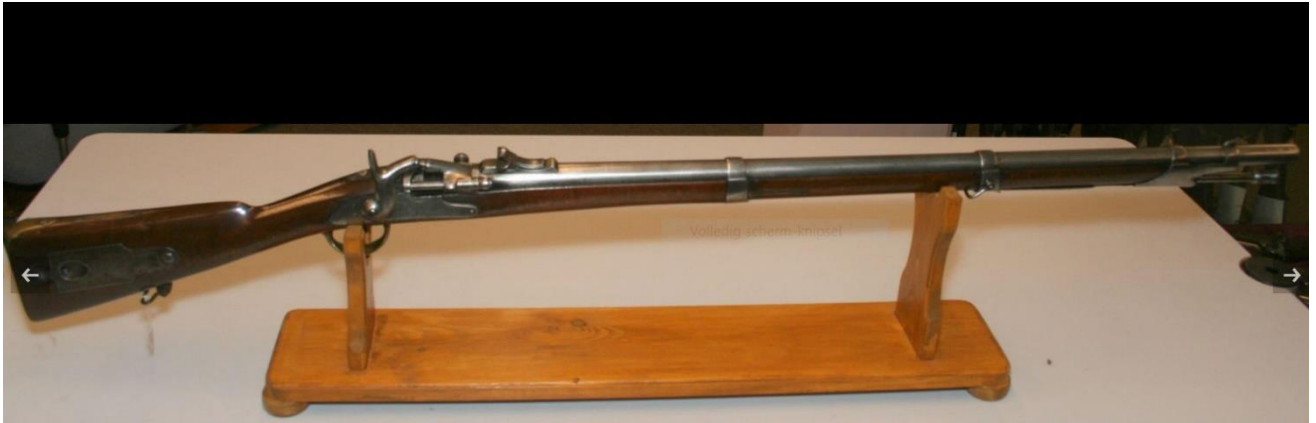
Enkelschots Achterlader Snider met een kaliber van 17,5 mm. Ingevoerd 1867.
